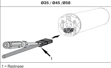
Stecken Sie die **spannungsfreie** Anschlussleitung soweit in den Antriebskopf, bis die Rastnase des Antriebes hörbar einrastet. Verwenden Sie gegebenenfalls zum Nachschieben einen passenden Schlitz-Schraubendreher. Setzen Sie diesen in eine der beiden dafür vorgesehenen Nuten am Stecker an.
