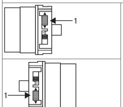
Schieben Sie den Drehrichtungsschalter (1) in die gegenüberliegende Position.
