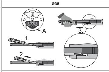
Stecken Sie einen passenden Schlitz-Schraubendreher mittig zwischen Rastnase und Rastzunge, so dass die Rastzunge die Rastnase am Stecker freigibt.
