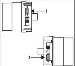
Schieben Sie den Drehrichtungsschalter (1) in die gegenüberliegende Position.
