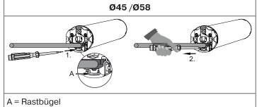
Stecken Sie einen passenden Schlitz-Schraubendreher mittig bis Anschlag in die Aussparung des Rastbügels, so dass der Rastbügel die Rastnase am Stecker freigibt.
