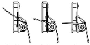
Die Zusatzabdeckung kann durch das bewegliche Schiebestück bei verschiedenen Gurtauslasswinkeln eingesetzt werden
