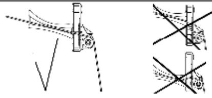
Gurtleitrolle mit Zusatzabdeckung so an die Wand halten, dass der Gurt in einer Flucht durch die alte und neue Gurtführung verläuft
