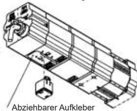
**Montage der QuickSnap-Kupplung für JAR**
