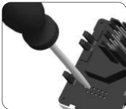
3. Nachdem der Schraubendreher wieder von den Kontaktflächen entfernt wurde, kann das Bedienteil wieder in das Installationsgehäuse eingesetzt werden.
