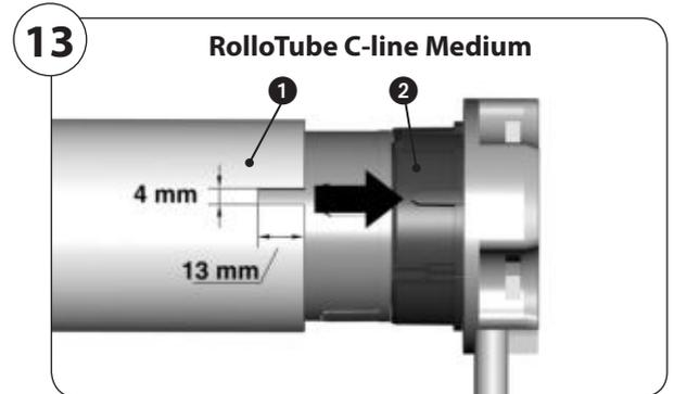
3. Schieben Sie den Rohrmotor in das Präzisionsrohr.
