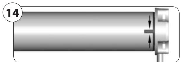
4. Markieren Sie vier Befestigungslöcher und bohren Sie diese anschließend durch das Präzisionsrohr in den Mitnehmer (**8**).
