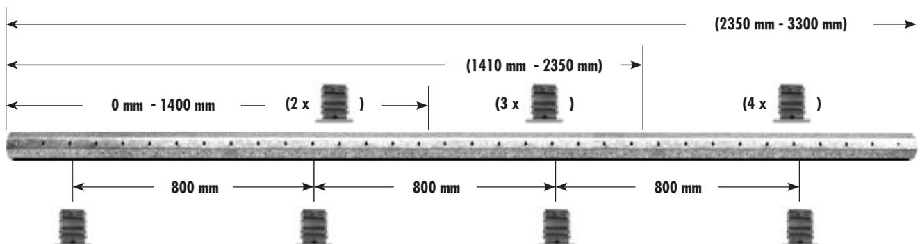
**Empfehlung:** Montieren Sie alle 800 mm einen weiteren starren Wellenverbinder.
