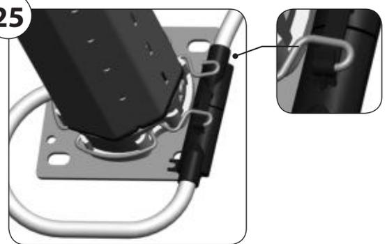
Der Federring (14) sollte bei Bedarf um 90 °gedreht aufgesteckt und wieder eingerastet werden.
