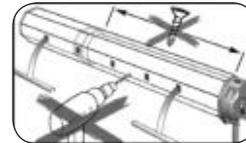
Das Bohren und Eindrehen von Schrauben im Bereich des Antriebs führt zur Zerstörung des Antriebs.
