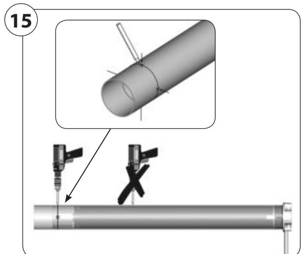
5. Das Präzisionsrohr am Mitnehmer (**8**) festschrauben oder vernieten.
