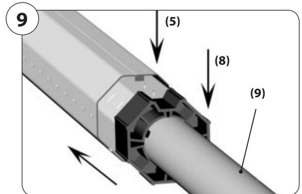
2. Drücken Sie danach die Wickelwelle (5) vollständig auf den Adapter (10).
