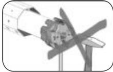
Das gewaltsame Einstecken des Rohrmotors (9) in die Wickelwelle (5) führt zu seiner Zerstörung.
