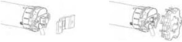
Außerdem können verschiedene Flansche oder Montageplatten vorgeschraubt werden. Bei Ablagerung mit Vierkant muss hinter dem Motorlager ein mechanischer Anschlag vorhanden sein, um ein axiales Verschieben des Vierkants zu verhindern.
