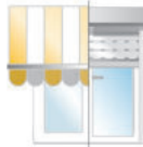
= Antrieb fährt nicht ganz bis zur oberen Endlage
