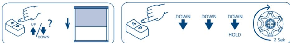
Danach mit der Auf- Taste die Markise in die gewünschte obere Endlage bringen; bei Kassettenanlagen die Auf- Taste solange drücken bis der Motor von selbst stoppt.
