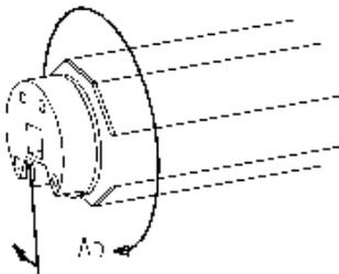
Wenn der Motor an der unteren Stellung weiterläuft und das ABS auskuppelt, Rolladen ca. 1/8 Wellenumdrehung hochfahren und Probekabel abschalten. Einstellhebel in Wellendrehrichtung "Ab" bis zum Anschlag durchdrücken und untere Stellung prüfen.
