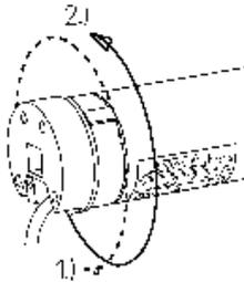
Die Stellung der Rolladenwelle wird über den Adapterträger an die Endabschaltung gemeldet. Ist der Motor nicht in die Welle eingebaut, läuft der Adapterträger nicht mit und die Endabschaltung funktioniert nicht.
