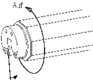
Rolladen in der oberen Endstellung nicht durch Loslassen des Einstellhebels, sondern durch Abschalten am Probekabel in der gewünschten Stellung anhalten (auch kurzes Antippen am Probekabel möglich).
