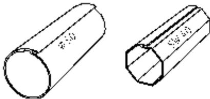
Verwenden Sie bei Mini-Rollläden die **SIRAL-Schnellmontagewellen**!!
