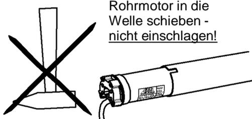
Rohrmotor in die Welle schieben - nicht einschlagen!
