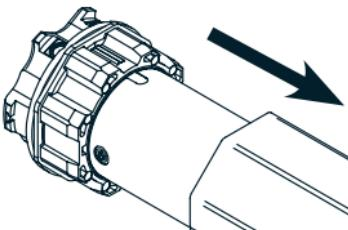
3. Den Motor vollständig in die Rulladenwelle einschieben.
