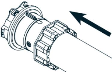
1. Den Adapter komplett auf die Nut des Endanschlagrings am Motor aufschieben.
