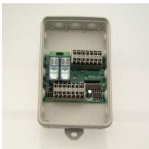
Flaches, Weichkunststoff-Gehäuse ohne Verschraubungen mit aussenliegenden Befestigungslaschen. Auf dem Deckel ist das Geräte-Anschlussbild aufgedruckt.
